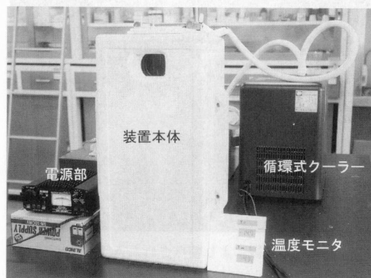
図7 2次冷却装置を取り付けた装置。
